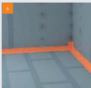
6 Dans le cas de plaques fermacell Powerpanel sol TE, le SPEC est uniquement appliqué en angles
