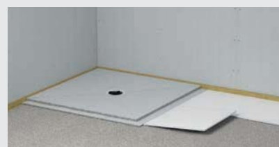
Mode de pose B : Pour compenser la hauteur de la battue du receveur de douche, poser une plaque de polystyrène expansé ou extrudé d'une épaisseur de 10 mm sur le ragréage
