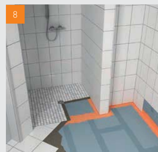
8 Les bandes de pontage servent également à traiter le raccord entre des plaques de sol fermacell ou fermacell Powerpanel sol TE et le receveur de douche à l'italienne fermacell Powerpanel sol TE
