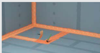
Poser et assembler par collage et vissage les plaques fermacell Powerpanel sol TE avec le receveur de douche. Traiter les angles ainsi que la jonction entre le receveur et la chape à l'aide de bandes d'étanchéité marouflées entre deux couches de SPEC
